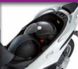
↑ Massima capacità di carico grazie al vano sottosella per 2 caschi demi-jet con visiera.
